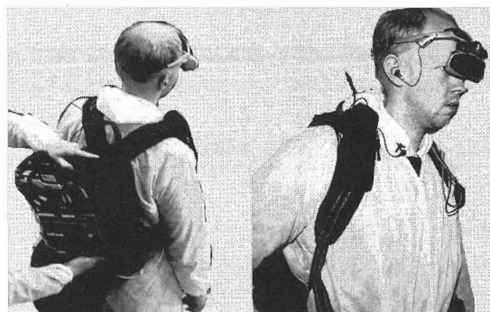
図4 放射線可視化システムの装着例
