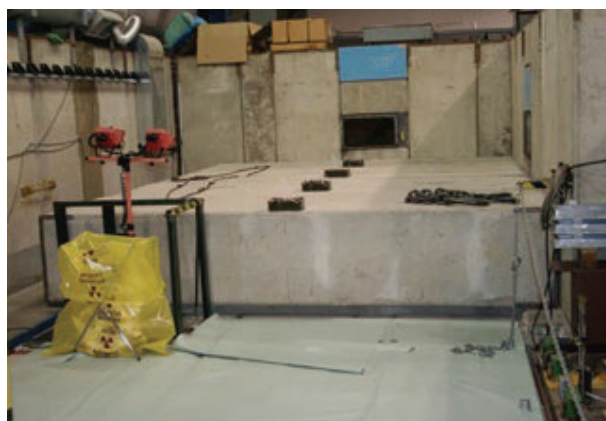
米国フェルミ国立加速器研究所反陽子ターゲットステーションにおける遮蔽実験の様子
