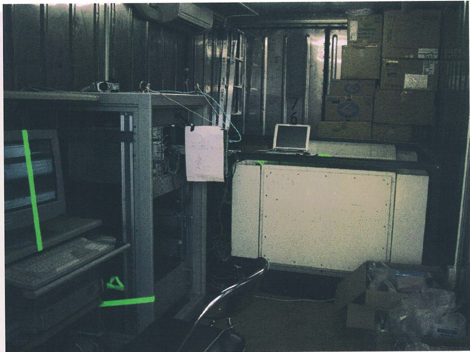
図 4: 「みらい」航海時のコンテナ内の様子。奥が送受信モジュール部、手前が送受信機とデータ処理装置。
