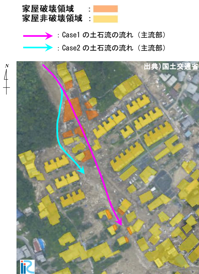
図 5.2.2 家屋の被災状況と家屋破壊の有無による土石流の流れ
