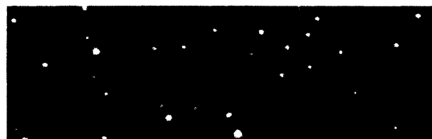
Fig. 2. 水銀表面に置かれたアクリル板を通して見たヘリウム気泡。画像の縦幅は 1.62 mm に相当する。
