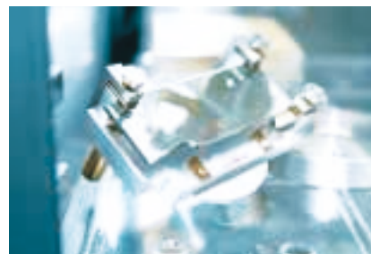
伊藤助教授が開発した高分解能蛍光X線結晶分光装置の生命線ともいえる「分光結晶」。 この鏡を介し、X線をあてた結果発生したスペクトルを検出することで、物質のさまざまな状態を調べることができる。
