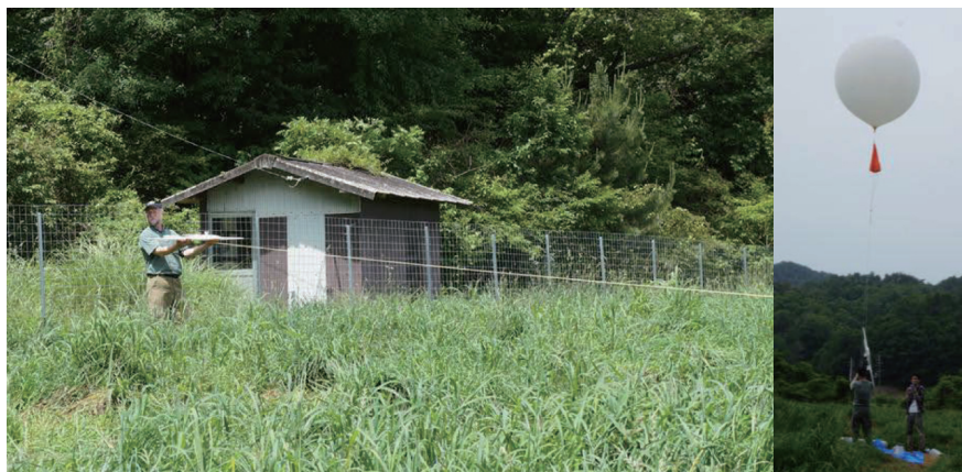
図1：UAV の離陸の様子。（左）Bungee 法。（右）Balloon 法。
