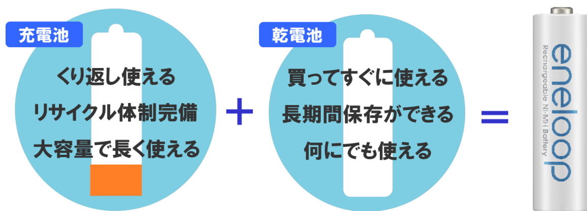
Fig.3-19 低自己放電タイプ(eneloop)の特徴
