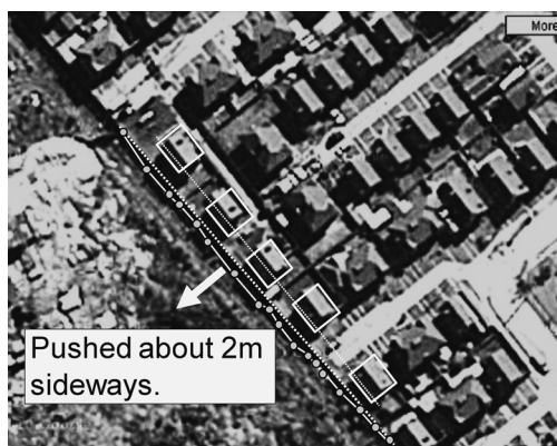
図18 被災前後の住宅の位置と被災後の境界部の変位 (ブリサ・デル・ソル)
