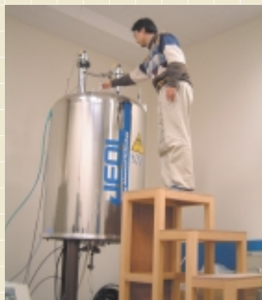
写真の垂直円筒部分は物質に強力な磁場を与える超伝導マグネット（ワイドボア型）で、高さ270cm、直径96cm。超伝導マグネットのほか分光器やコンピュータもある。ECA500-WB型。
