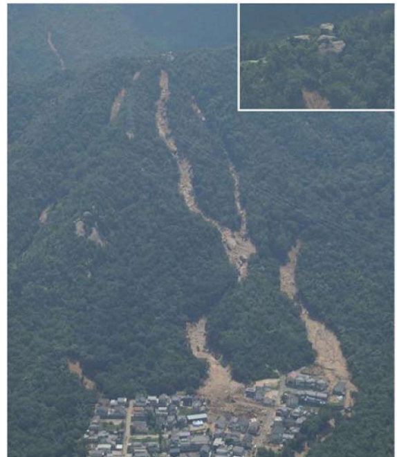
図1 安芸郡熊野町川角地区の崩壊・土石流。挿入写真は崩壊源の直上にある岩塔。これと同様の岩塔は、写真左手中央部にも認められる。
