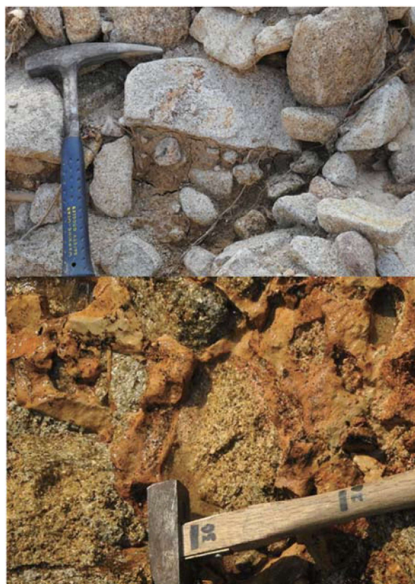
図11 新しい土石流堆積物（上）と古い土石流堆積物（下）。古い土石流堆積物では、基質が粘土化している。
