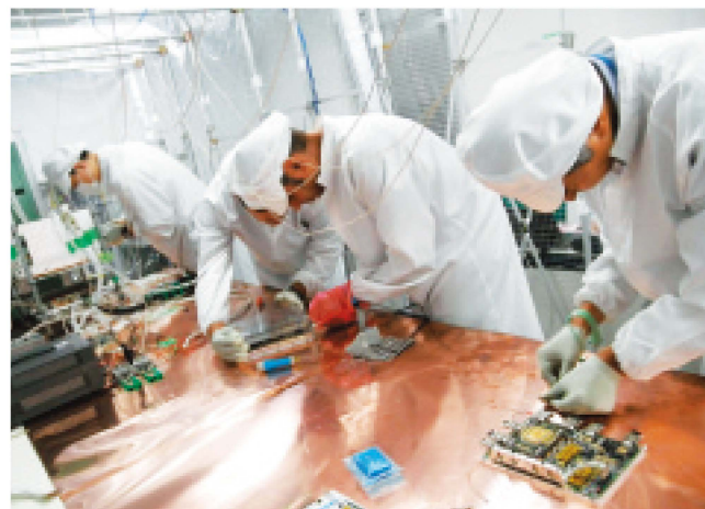
各国からもちよった装置基板をクリーンブース内にセッティングしていきます
