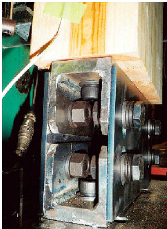
写真2 新機構の摩擦接合部が広がっている状態
