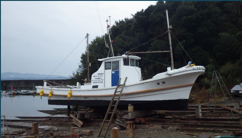
造船所での上架作業(1～2回/年)
