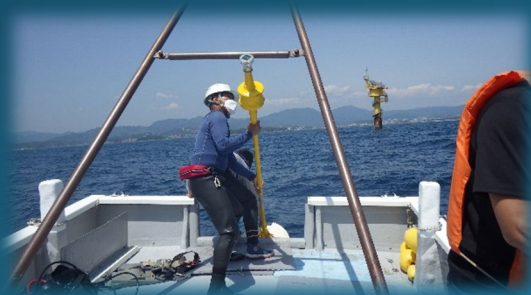
波浪ブイ設置作業
