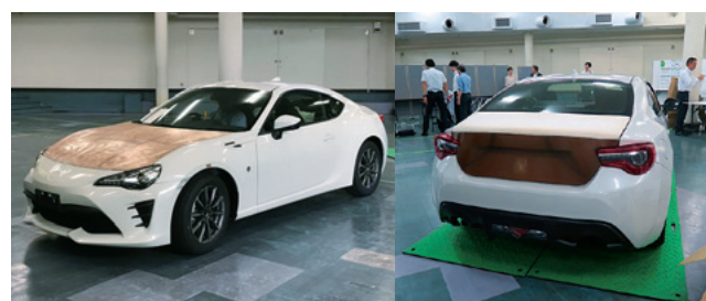
図1：試作車1号(左) エンジンフードをRTM試作品(CNF+エポキシ樹脂)に置換(右) トランクリッドをCNF100%とPA6-CNF5%射出成形品に置換(2018年6月6日成果報告会にて)
