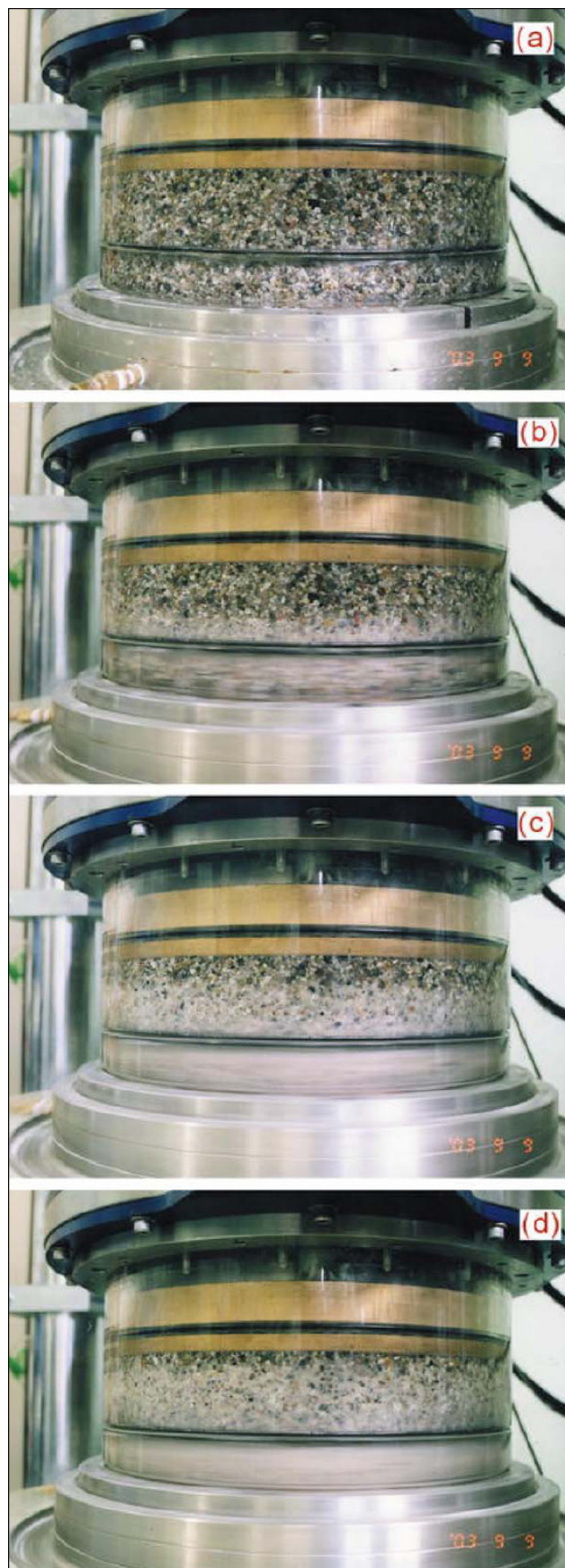
図10 可視型試験機におけるせん断中のせん断ゾーンにおける粒子破碎の進行
