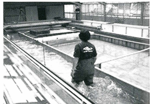
写真6-4 通路模型（幅1 m、30 m）
