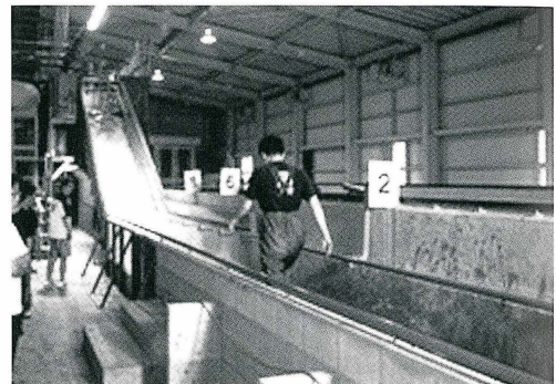
写真6-3 階段模型（幅1 m、30段）
