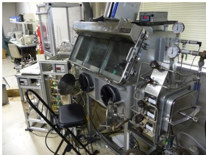
図 3-1-1 ガス循環精製装置付きグローブボックス。
