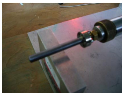
図 3-6-3 パルス中性子回折実験に用いたバナジウム製密閉型試料セル。
