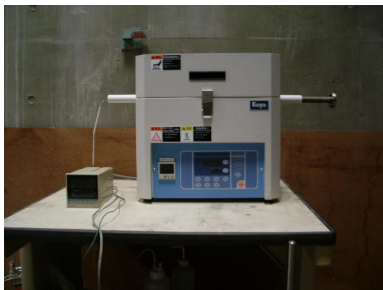
図 3-1-6 ガラス試料の熱処理に用いた管状型電気炉。
