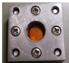
図 3-5-3 放射光 X 線回折実験に用いた密閉型試料セル。
