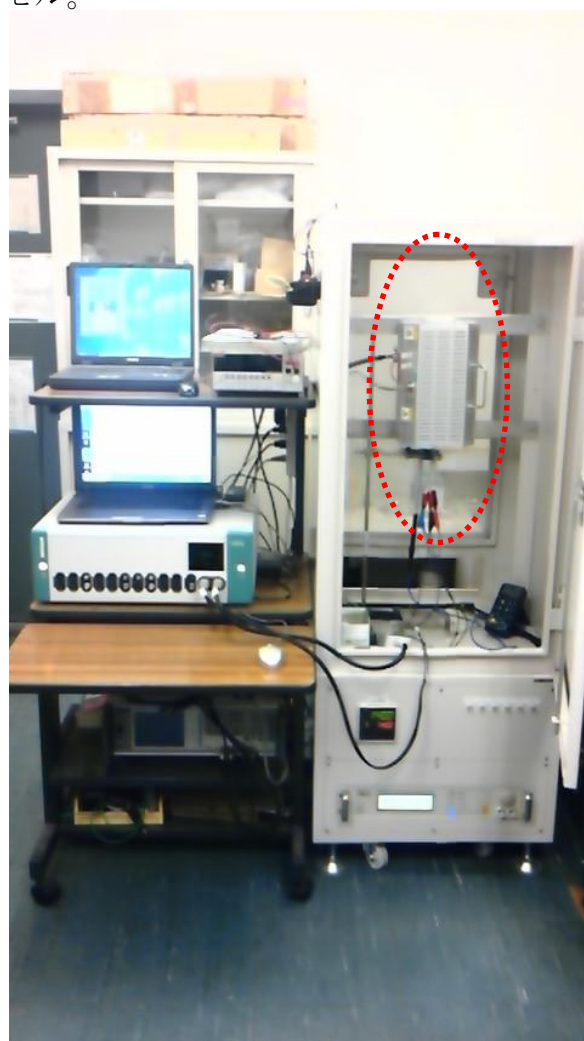
図 3-4-2 交流インピーダンス測定の様子。試料セルは点線で示された電気炉内に設置されている。
