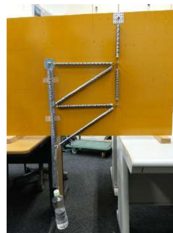
図4 バネによるトラス構造
