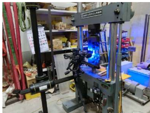
図3 画像計測によるひずみ制御サイクル試験
