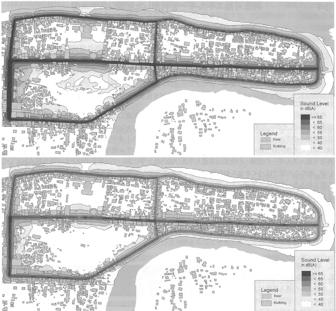
図4 L_{day} に関する電動車両導入前（上図）および導入後（下図）のサウンドマップ
