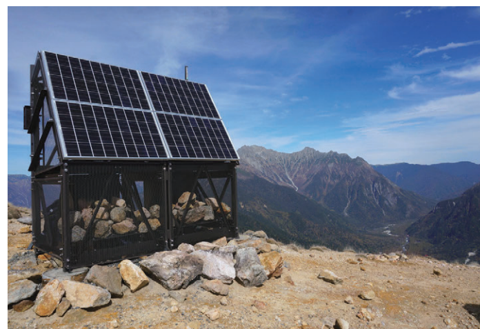
焼岳山頂に構築した常時観測点。標高2400m。地震、地殻変動、全磁力等を観測する。後方は穂高連峰と上高地。
