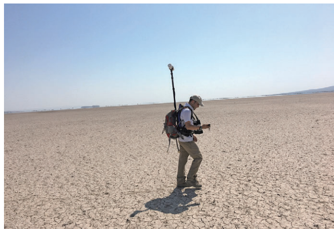
写真1 磁力計は胸元に、磁力計センサーは背負って一定の高さで計測。リュックの空きスペースにはともかく水を詰め込む
