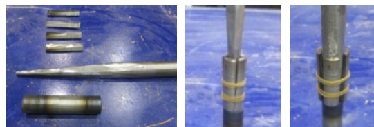
写真-1 膨張部分の試作 (左：部品、中：初期、右：膨張時)
