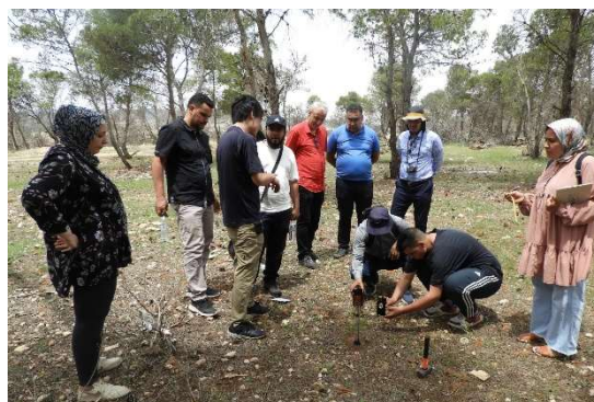
(b) 焼損域での変水位透水試験 (峠特定准教授)
