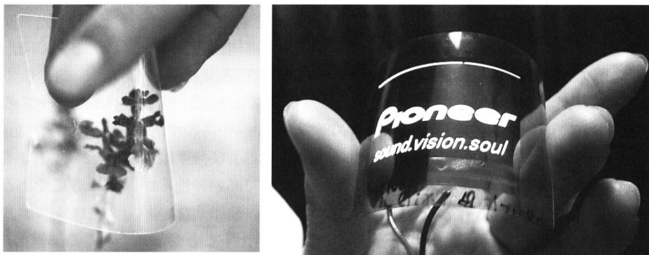
図3：セルロースナノファイバー補強透明材料（左）とそれを基板に用いた有機EL発光素子（右）
