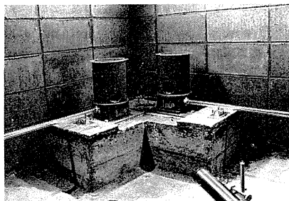
写真-2・25 水晶管伸縮計拡大装置（屯鶴 峯地殻変動観測所）
