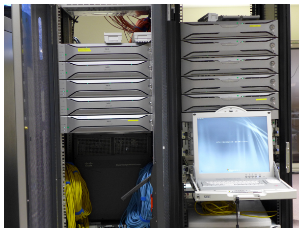
図 4: NEC iStorage NV7500 と管理コンソール. 水害などからユーザのホームディレクトリのデータ領域を守るために筐体をラック上部に配置している.
