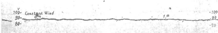
第 3 圖 c 定電位(風速一定), ラヂオトリウム電器, 電位計 No. 2
