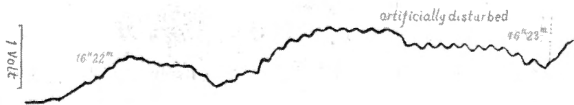
第 19 圖 空中電場の人爲的振動, 空中導體(2), 檢流計
