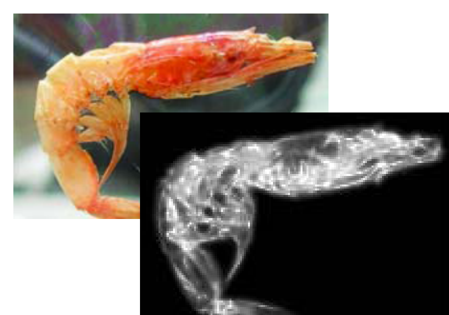
(上) エビのテラヘルツ非破壊透過像 (右) 郵便物の麻薬検査 [1]
