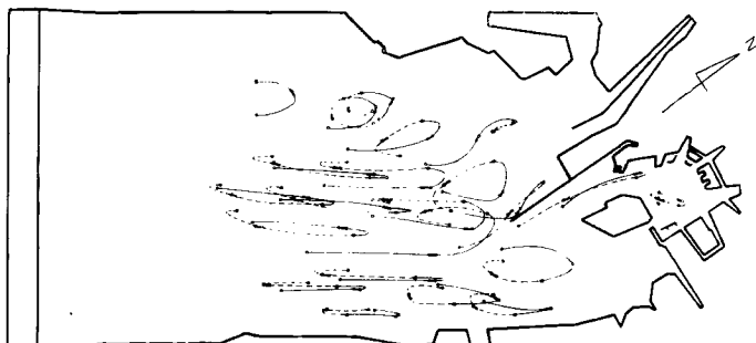
Fig. 8 Tidal locus (Case-A, H=2.6 m, d=9 m)
