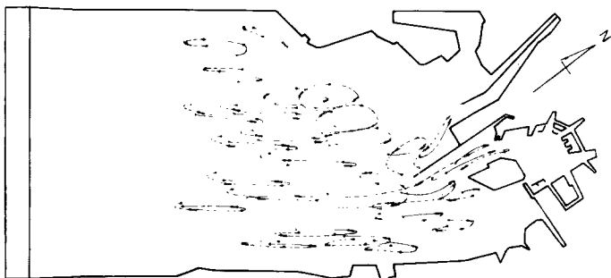
Fig. 9 Tidal locus (Case-A, H=2.6 m, d=12 m)
