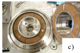
写真-1 各試験種のせん断箱 (a:単純，b:一面，c:リング)
