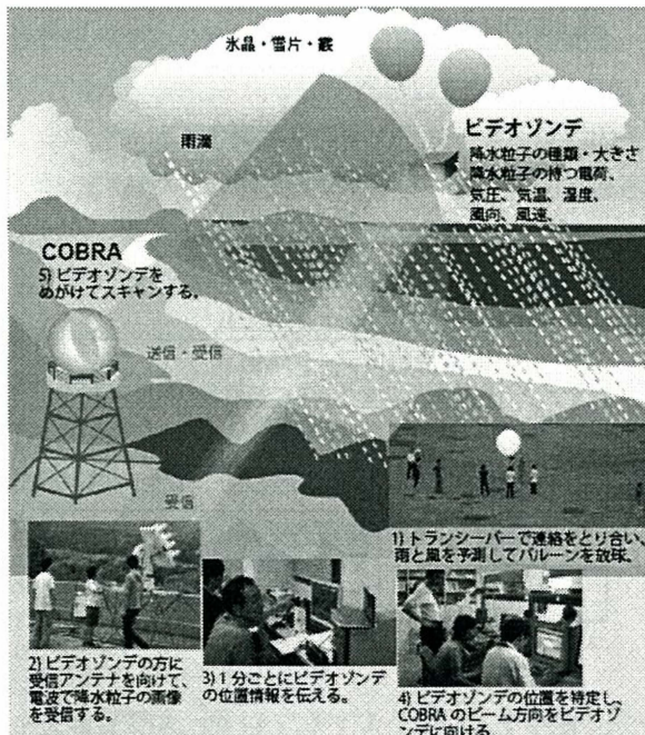
図 6 ビデオゾンデと最新型 5cm 波偏波レーダーとの同期観測
