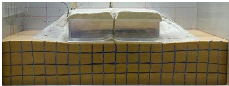
図 6 液状化地盤上におけるボックスカルバートの目開き再現実験
