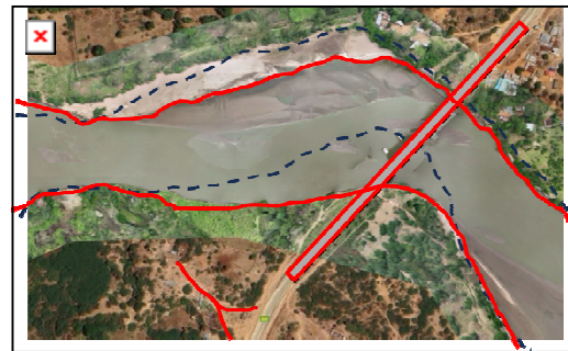
図-12 Sabaki Bridgeの洗掘面積の抽出
