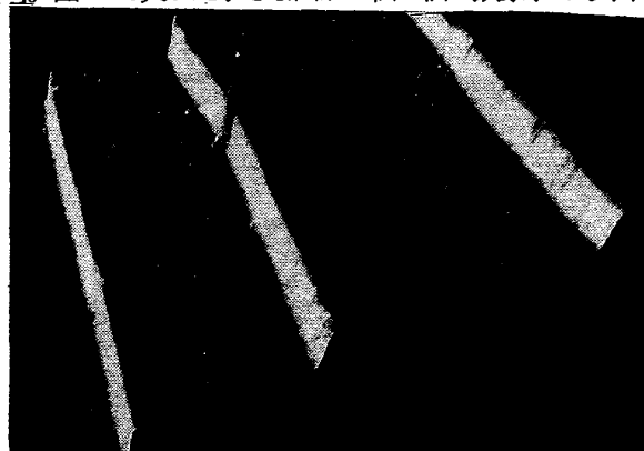
図26. \text{Cu}(111) 清浄表面のconstant-current像( V_t = 0.1 \text{ V} , I_t = 1.0 \text{ nA} )、温度 4.2 \text{ K} [17]。
