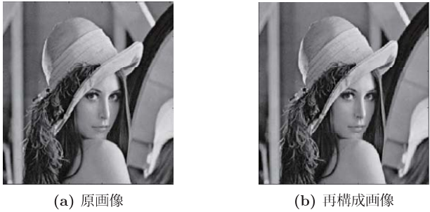
図 11: 原画像と再構成画像の各値 (PSNR=64.12, SSIM=0.99)
