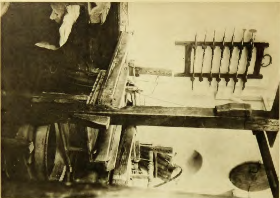
同上 鋸錐を動かす足踏み機構、梁上にあるは各種の鋸錐
