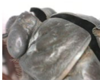
「溶融できないマトリクス」(セミ殻キチン、鶏腿コラーゲン)をコンポジット化した例。
