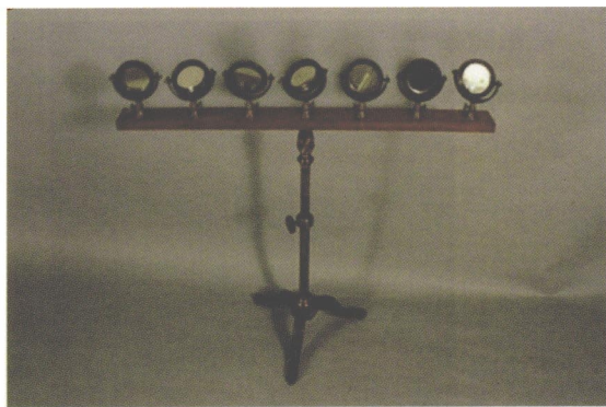
図1. 7鏡による光の再合成器 (明治35年購入、京都大学総合博物館蔵)
