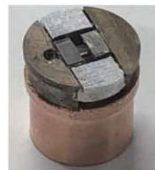
図 1 Thermal contraction strain cell (OD 9.5 mm).
