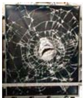
加撃体貫通 フィルム厚 350 μm 全面貼り
