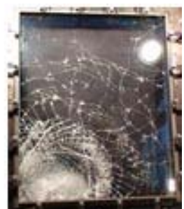
加撃体貫通なし フィルム厚 450 \mu m
