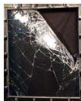
加撃体貫通 フィルム厚 450 μm 部分貼り
