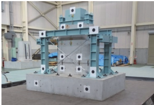
写真-2 振動台実験供試体 7)
