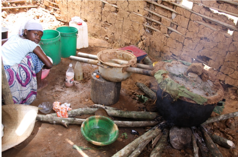
図 3. 蒸気に含まれるエチルアルコールが筒を通る間に冷やされ、蒸留酒となる。
