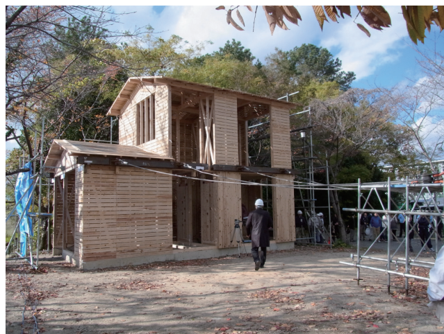
写真1 壁柱工法で補強した実大試験体
