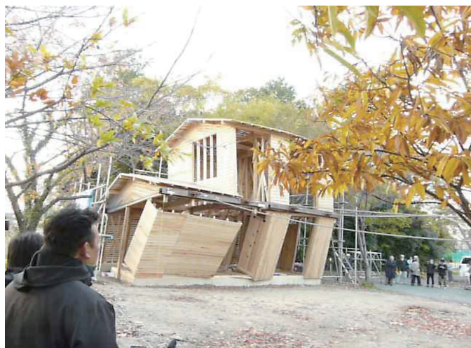
補強試験体の倒壊直前の状況 (4P)
