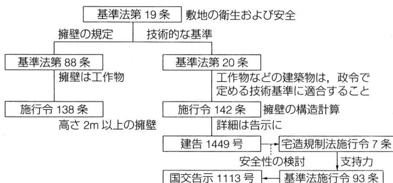
図-2 擁壁に関する建築基準法の規定の概要 2)
