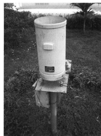
図 2：Acacia Center に設置されている転倒ます型雨量計
