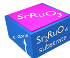
図 1: スピン三重項超伝導体(TSC) \text{Sr}_2\text{RuO}_4 の結晶に強磁性体(FM) \text{SrRuO}_3 の薄膜を載せた概略図。
