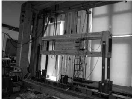
写真 5 鋼製反力フレーム
