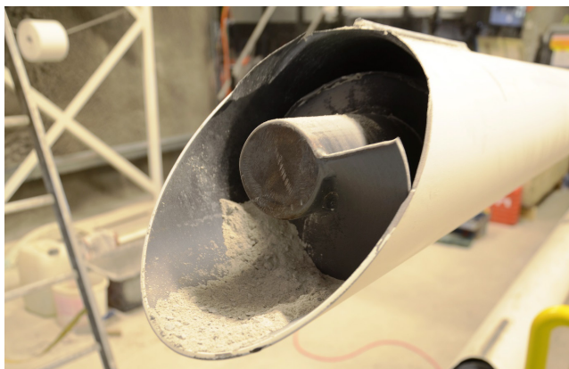
図4 スクリューフィーダの先端部。スクリー回転により粒状ベントナイトを押し出す
