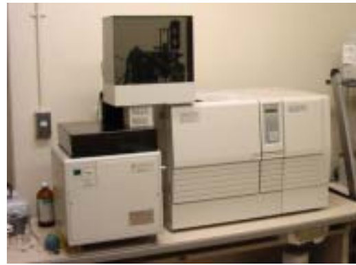
写真：地盤環境影響物質の微量分析装置；(左)高周波プラズマ発光分析装置による分析。ネブライザ、チェンバ1)より霧化した試料をプラズマ2)内へ導入する。高周波融合プラズマによって試料に電気/熱エネルギーを与えることにより発光させ、放射された光を3)を通して内部の分光器により各元素固有のスペクトル線に分け、スペクトル線の有無と強度から試料中の元素の定性/定量分析を行う。無機汚染物質に適用。(右)ガスクロマトグラフ質量分析計。有機系汚染物質の定性/定量分析に適用。
