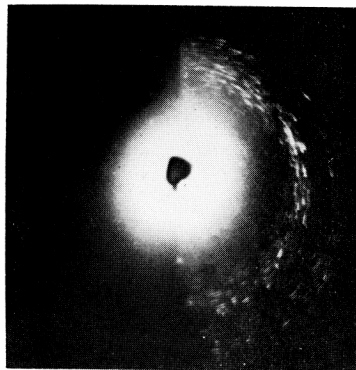
第十一圖 固溶體 Al+Cu を 150°C にて數時間焼鈍せしもの (Cu K \alpha )
