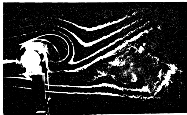
第5図 可視化写真 U_0 = 10 \text{ m/s} , 時計方向回転
